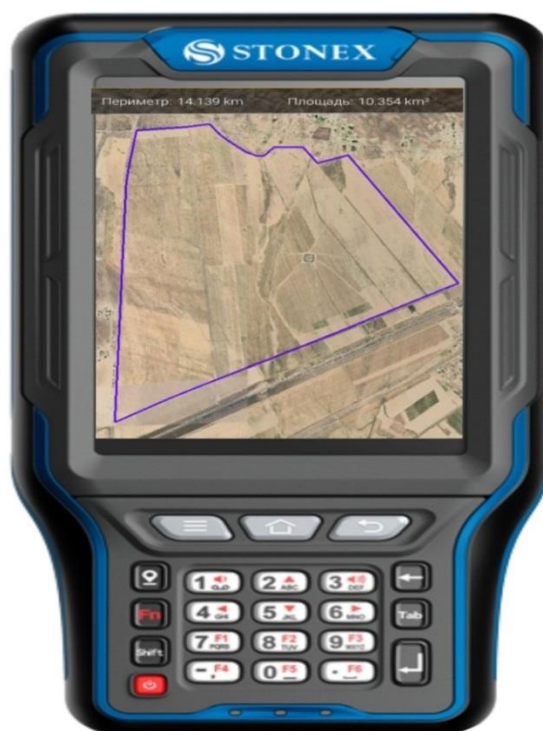
4-rasm. “GNSS STONEX S9 II” geodezik asbobi yordamida o‘lchangan maydon yuzasi
